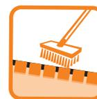
**5.** Nach 15 min. mit einem feinen Haarbesen die Endreinigung durchführen bis die Oberfläche von allen Mörtelresten befreit ist. Abgekehrt wird Diagonal zur Fuge.
