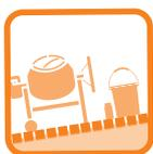
**2.** Den Quarzsand mit dem Flascheninhalt mind. 6 Min. mischen bis eine homogene Vermischung erreicht ist.
