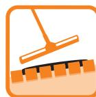
**4.** Arbeiten Sie den Mörtel mit einem Hartgummischieber verdichtend in die Fugen ein. Verarbeitungszeit ca. 20-30 Minuten.
