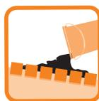
**3.** Geben Sie das Mischgut verteilt auf die Fläche. Um die Fließfähigkeit des Mörtels besser zu nutzen, den Mörtel an 3 bis 4 Stellen im Verfugungsbereich ausschütten.
