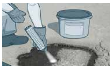
2. Arbeitsschritt: VORSPRÜHEN (empfohlener Arbeitsschritt – nicht zwingend notwendig!)
