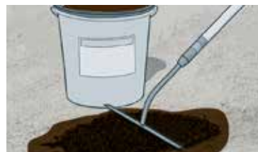
3. Arbeitsschritt: SPLITTSPITZEN SCHARF ABZIEHEN (mit dem Moosgummischieber in den Asphalt einarbeiten)
